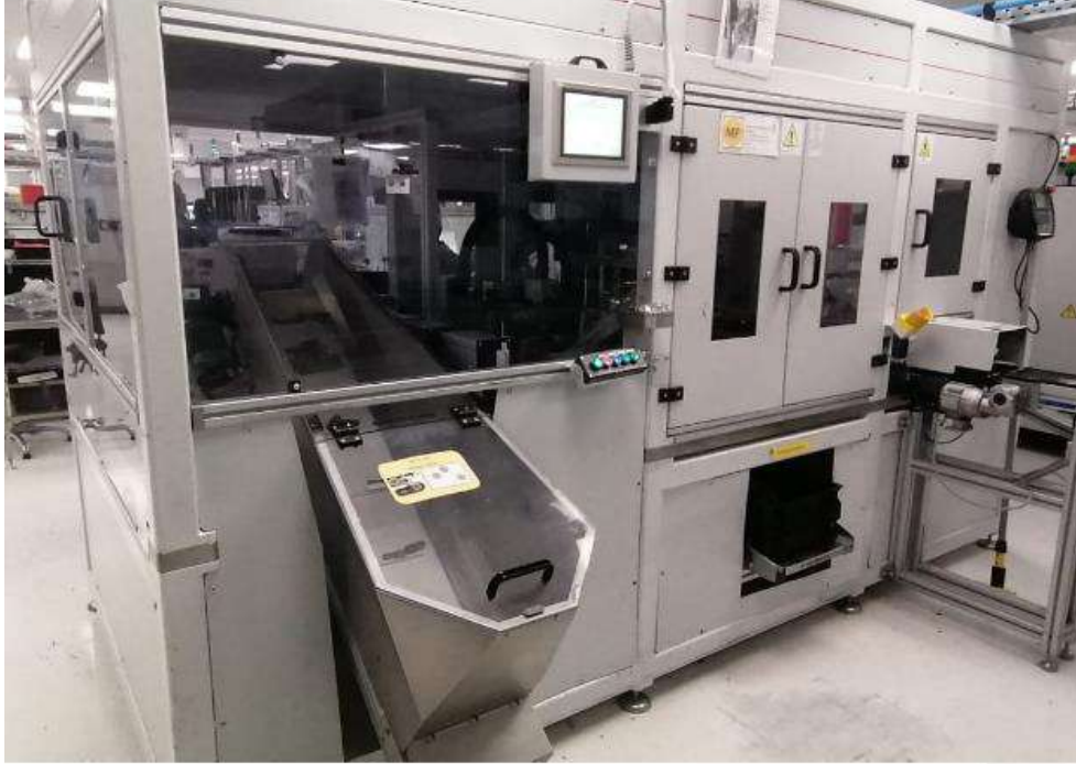
Ilustración 8: Estación de inserción de antena en enclosure
