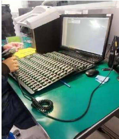
Ilustración 19: Estación de inspección de soldadura y escaneo de material.
