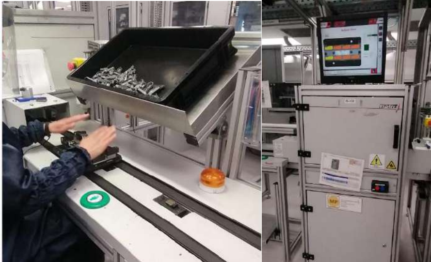
Ilustración 9: Estación carga e inspección de enclosure
