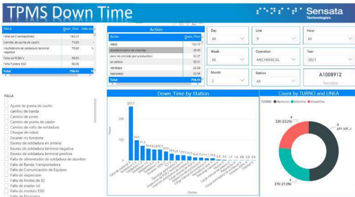
Ilustración 21: Sistema power BI del ANDON para indicar los paros en las operaciones
