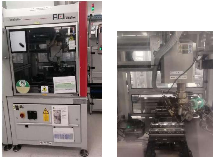
Ilustración 14: Estación de soldadoras
