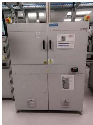
Ilustración 17: Estación de marcado y lectura de código laser
