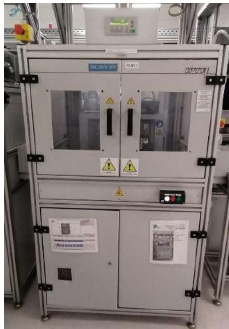
Ilustración 12: Estación de estacado de pin plástico
