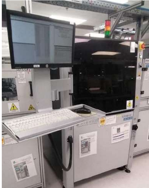
Ilustración 15. Estación de inspección de soldadura aplicada en las terminales de batería y antena.
